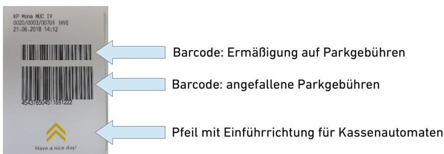
**Vorsicht: Ein zweimaliges Einführen des Tickets führt dazu, dass zwei Barcodes übereinander gedruckt werden. Beide Barcodes sind dann nicht mehr lesbar. Die Anlage erkennt dann die Ermäßigung nicht mehr.**
